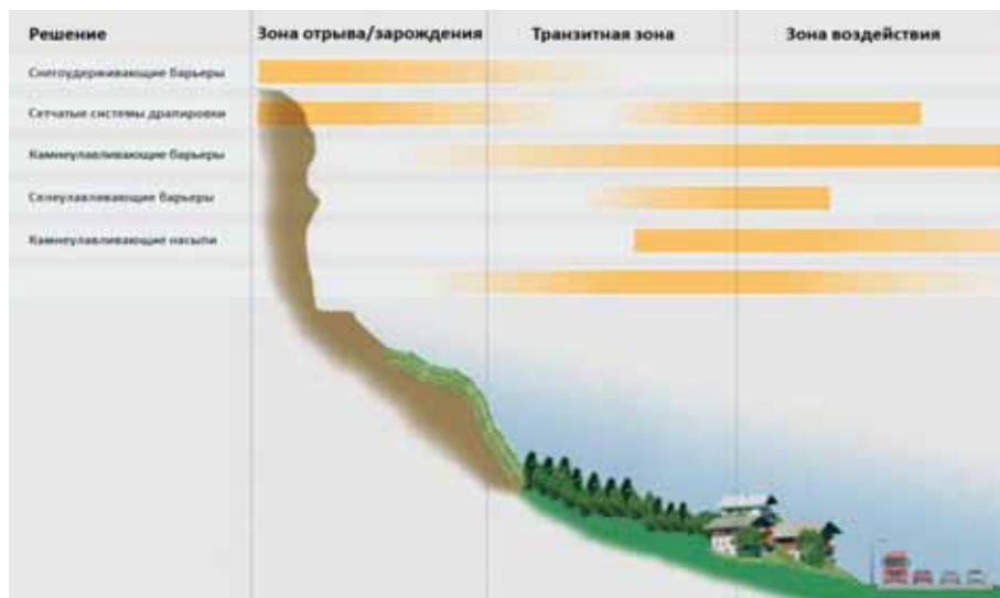
Рис. 1. Зонирование склона с точки зрения протекания гравитационных процессов
