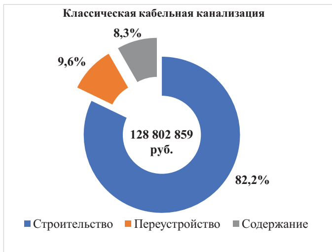
Рис. 4. Структура дисконтированных затрат по видам работ и интегральные дисконтированные затраты для классической кабельной канализации
