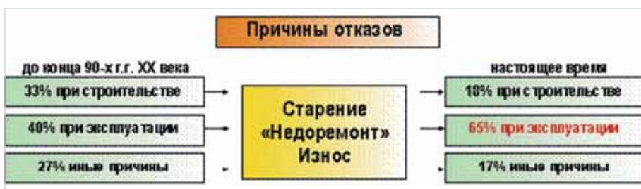
Рис. 4. Причины аварийных ситуаций на мостах
