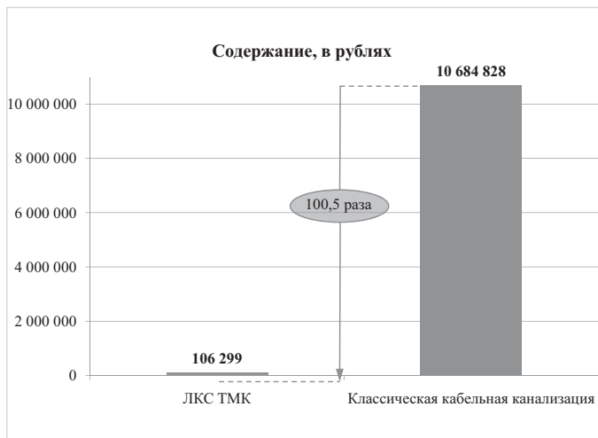
Рис. 7. Сравнение дисконтированных затрат на содержание по каждому из принятых вариантов кабельной канализации
