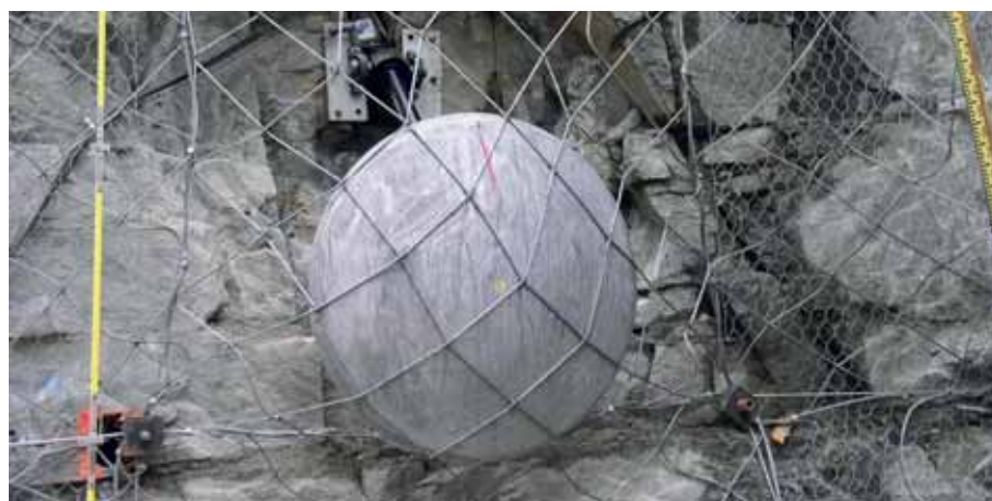
Рис. 2. Тест на продавливание
