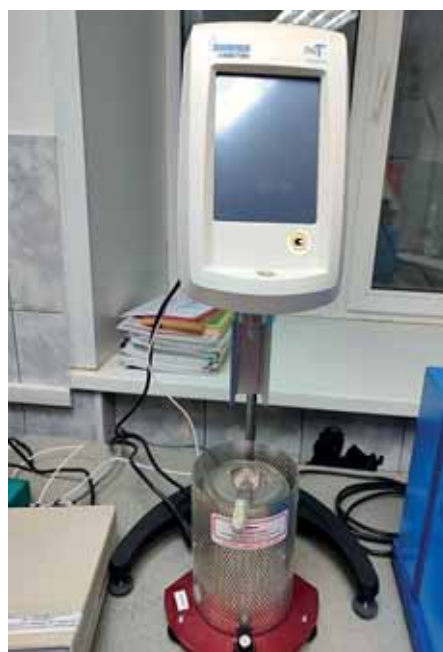
Рис. 3. Ротационный вискозиметр и его цифровой дисплей
