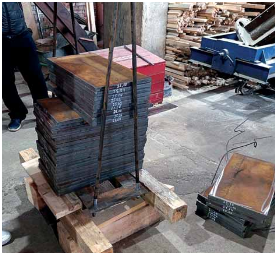
Испытания на вырыв. Нагрузка более 1 т
