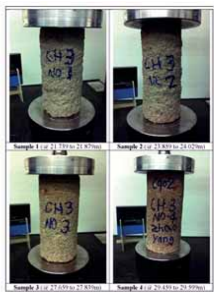
Рис. 8. Испытание образцов кернов из грунтобетонных свай
