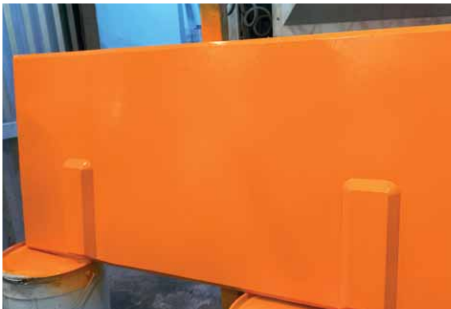
Карнизный блок из СПФБ, окрашивание
