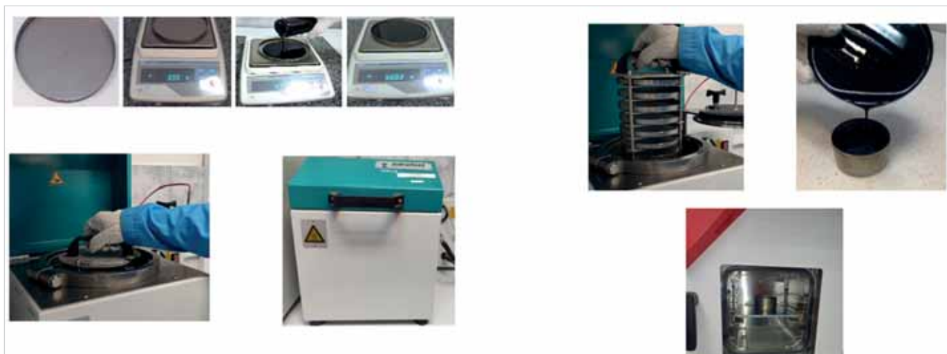
Рис. 6. Этапы проведения старения битумного вяжущего PG 64-40 по методу PAV
