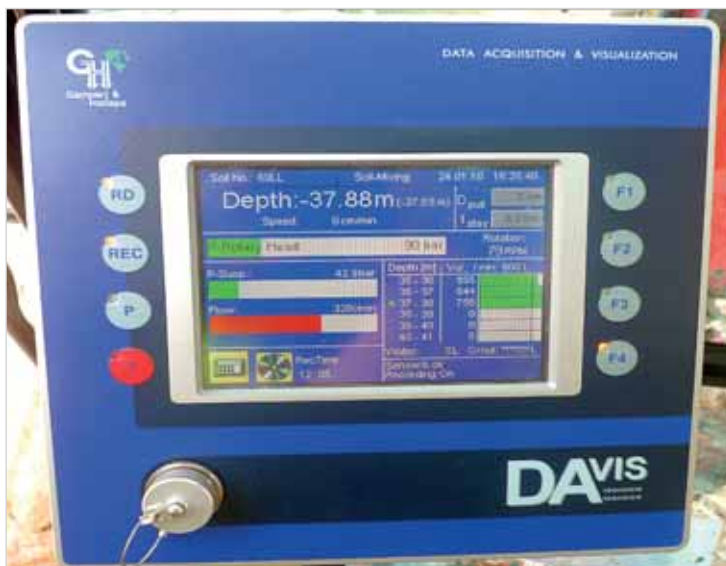
Рис. 4. Монитор контроля качества при глубинном смешивании грунтов
