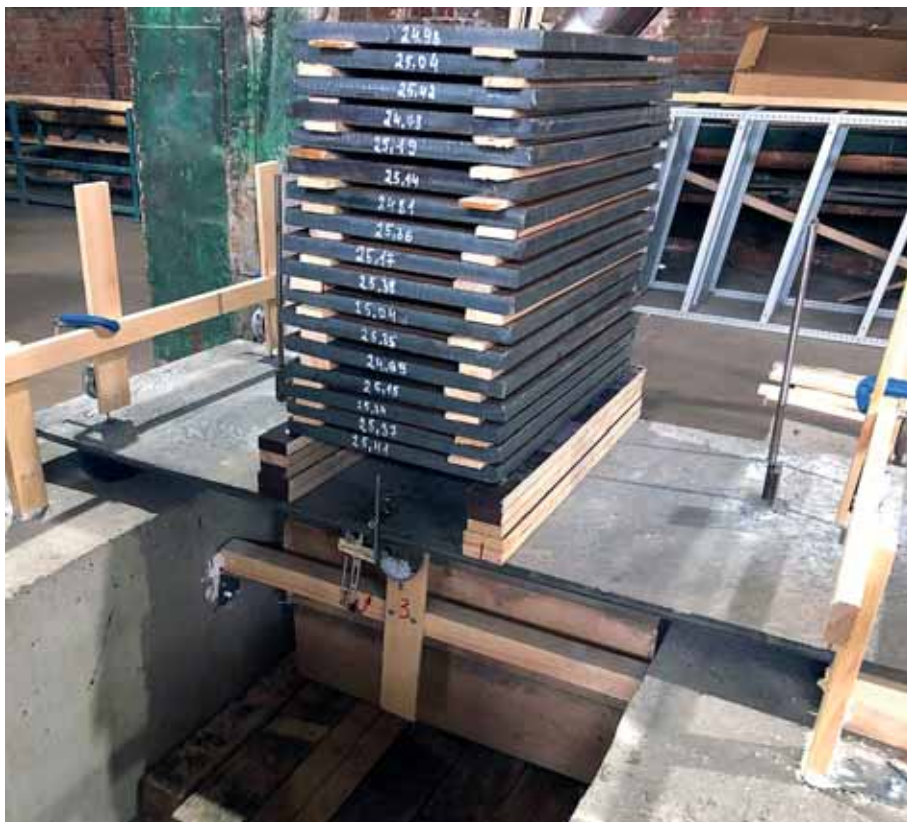
Испытания на изгиб. Нагрузка более 425 кг
