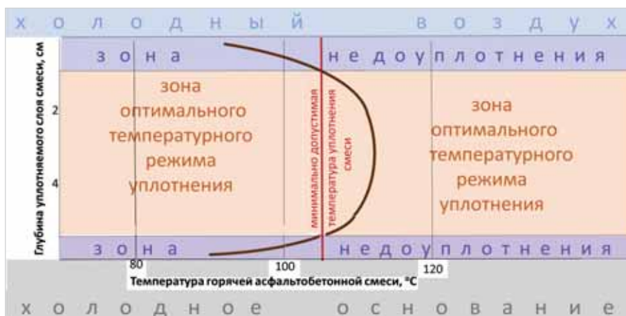
Рис. 2. Распределение температуры в уплотняемом слое горячей смеси по его глубине
