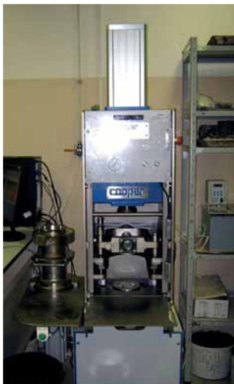
Рис. 4. Вращательный уплотнитель (гиратор): слева – отечественного производства, справа – импортного
