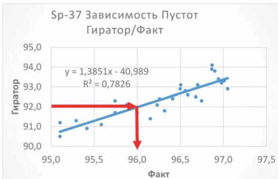
Рис. 5. Зависимость относительной гираторной плотности от фактической
