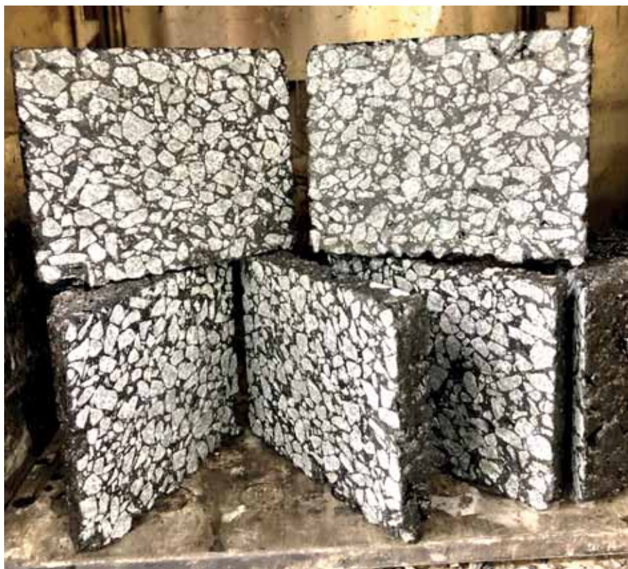
Рис. 2. Высококонтактная структура ЩМА-15V
