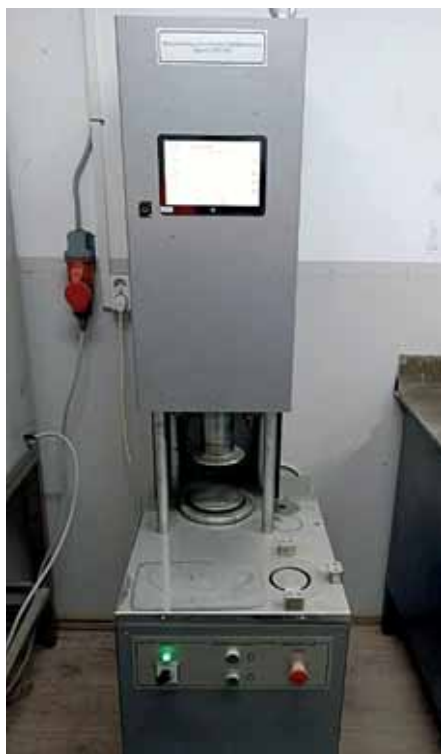
Рис. 4. Вращательный уплотнитель (гиратор): слева – отечественного производства, справа – импортного
