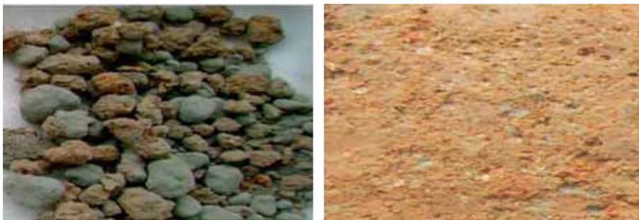
Рис. 6. Вторичные агрегаты грунта (суглинка) и цемента после перемешивания смеси и распределение цемента в суглинке после перемешивания и уплотнения при одновременном введении в смесь воды и вяжущего
