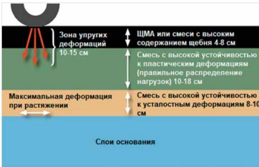
Рис. 3. Распределение нагрузок из концепции «вечных» дорог
