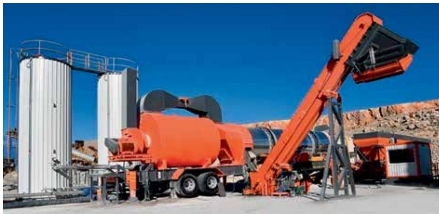
Рис. 1. Пример размещения стационарного завода OKUR DRUMMIX мощностью 120 т/ч в Центральной Анатолии
