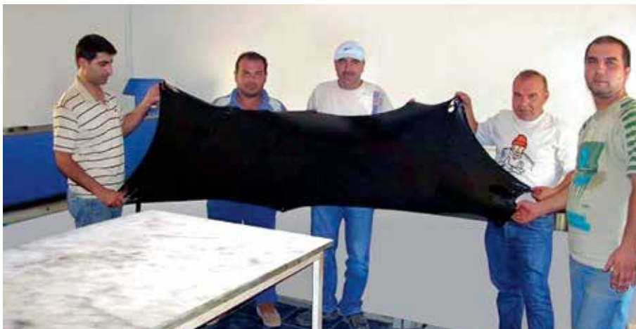
Рис. 6. Демонстрация повышенной эластичности полимерно-битумного вяжущего, произведенного на оборудовании для модификации битума полимерами OKUR PMB 20MP
