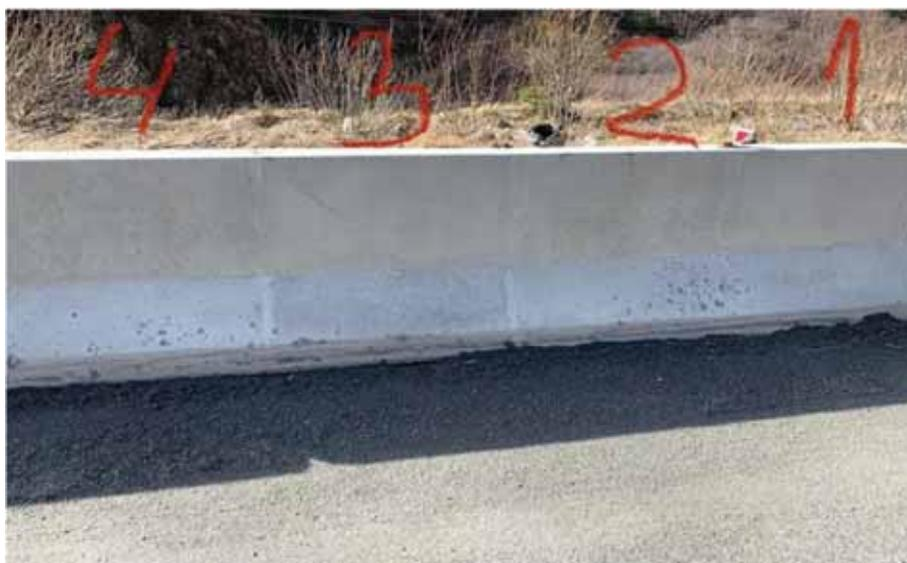
Фото 1. Обозначение зон: 1 – гидрофобизатор на растворителе для дорожного строительства; 2 – гидрофобизатор на водной основе для общего строительства; 3 – гидрофобизатор на растворителе для общего строительства; 4 – контрольная
