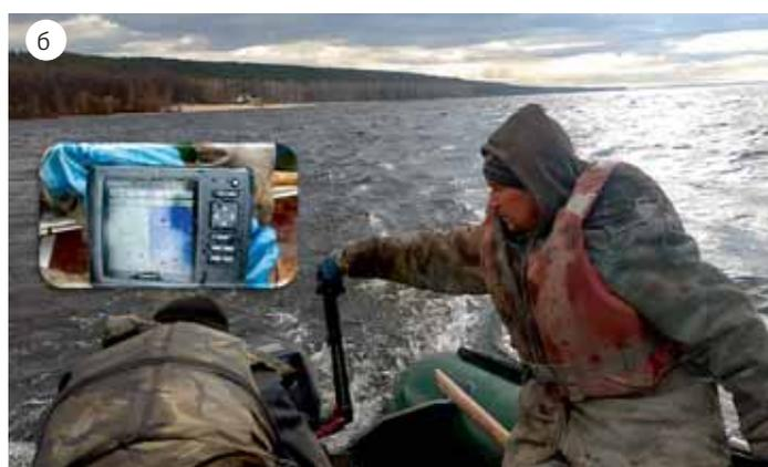
Рис. 8. М-12 Москва – Казань. Контроль проведения гидрологических работ: а) II этап, Владимирская область, июнь 2020 года. Русловая съемка на реке Ворше; б) VIII этап, Республика Татарстан, октябрь 2019 года. Промеры глубин реки Волги с моторной лодки
