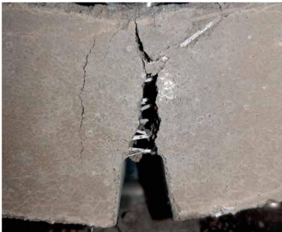
Разрушение фибробетона, армированного синтетической макрофибр
