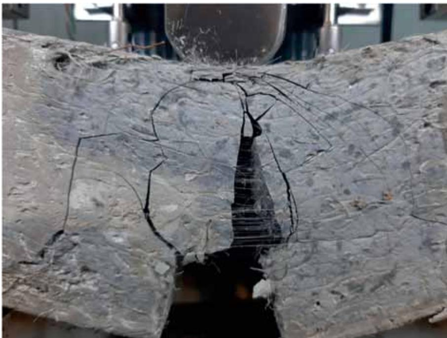
Разрушение фибробетона, армированного синтетической микрофиброй
