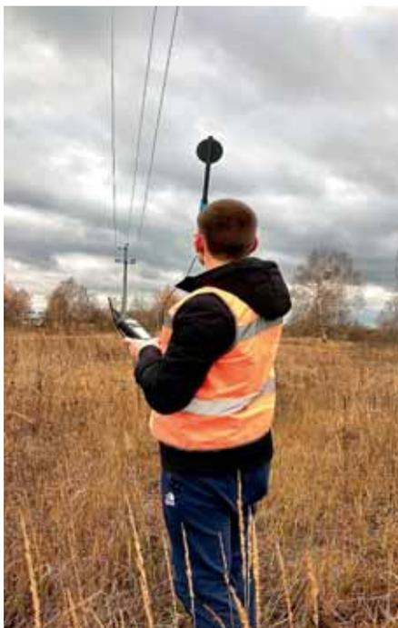
Рис. 6. Выполнение замеров электромагнитного излучения
