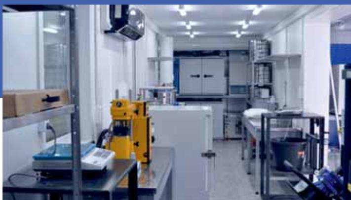
Мобильные лаборатории выполняются на базе вагончиков / морских контейнеров с теплоизолированными стенами, приточно-вытяжной вентиляцией, дополнительным подогревом, ярким освещением, рационально размещенной лабораторной мебелью и сантехникой, что позволяет эксплуатировать ее в полевых условиях в самых разных регионах.
