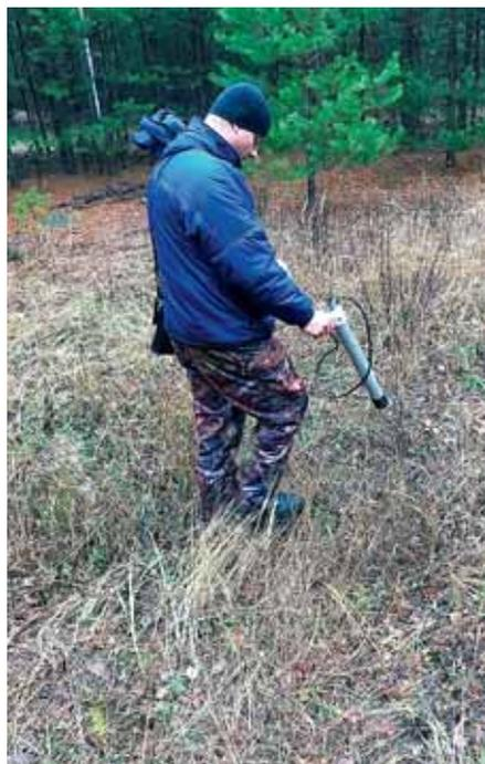
Рис. 7. Выполнение замеров гамма-излучения
