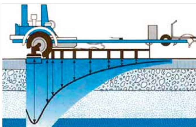
Рис. 2. Регистрация экспериментальной чаши прогибов с использованием установки ударного нагружения
