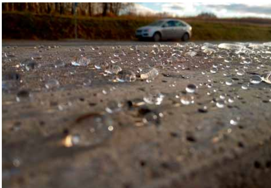
Капля на осевой линии (Несмотря на почти художественную эстетичность биддинг-эффекта, это – некорректный способ проверки качества гидрофобизации)
