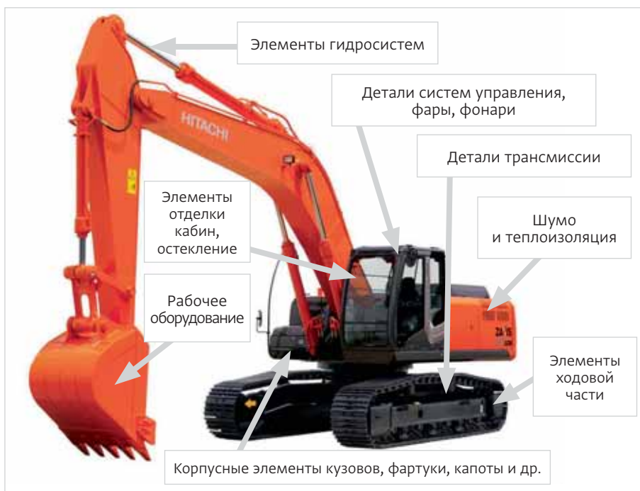
Рис. 3. Основные области применения полимерных материалов и аддитивных технологий при производстве гусеничных ковшевых экскаваторов
