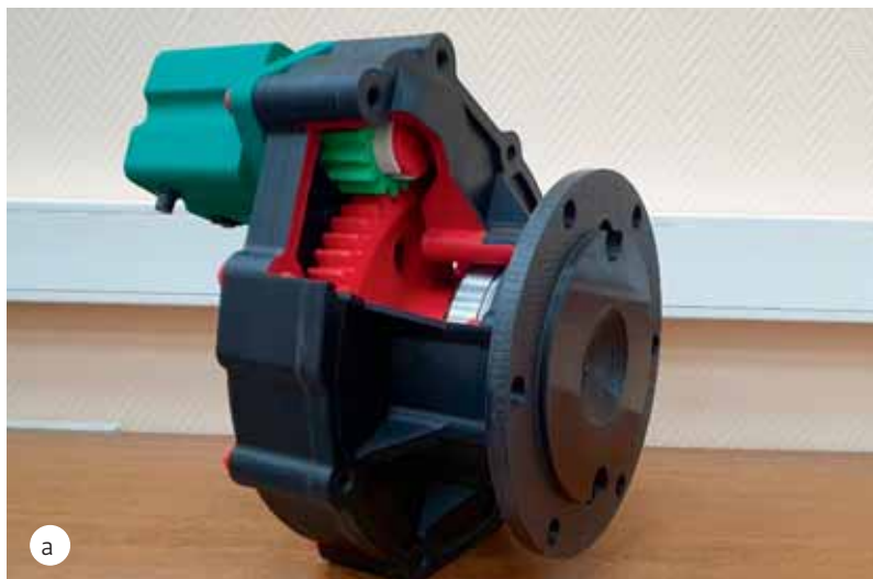
Рис. 4 – Общий вид изготовленного с применением аддитивных технологий: а) одноступенчатого редуктора ; б) корпуса гидроаккумулятора гидромолота
