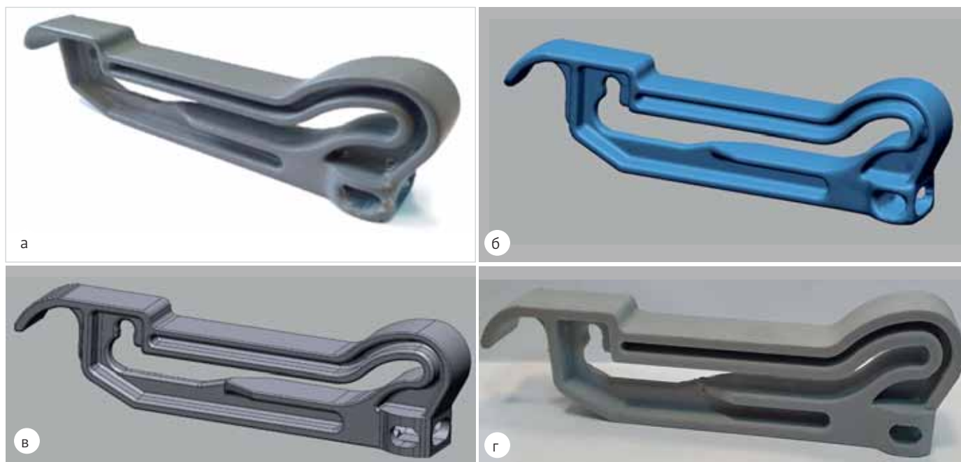
Рис. 5. Этапы реверс-инжиниринга: а) оригинальная поврежденная деталь; б) полигональная 3D-модель; в) твердотельная 3D-модель; г) новая деталь, изготовленная методом 3D-печати
