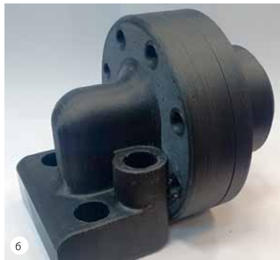
Рис. 4 – Общий вид изготовленного с применением аддитивных технологий: а) одноступенчатого редуктора ; б) корпуса гидроаккумулятора гидромолота
