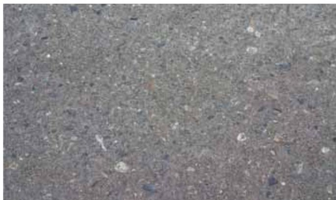
Рис. 4. Текстура поверхности покрытия из битумоцементобетона на битумной суспензии
