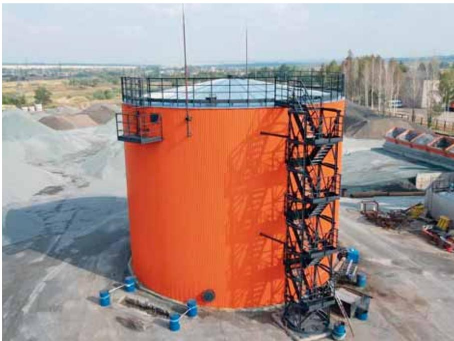
«АсфальтМаш» специально разработана для хранения битума при соответствующих требованиям наименьших температурах. Это положительно сказывается на качестве битумного материала, а впоследствии и на эксплуатационных качествах конечного продукта – автомобильной дороги.
