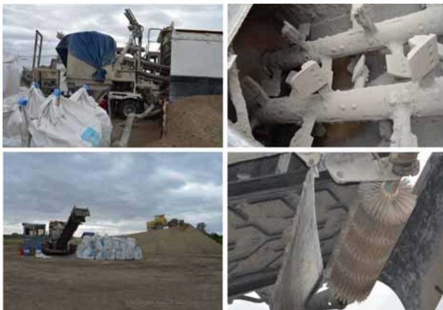
Рис. 1. Узлы подачи компонентов смеси в мешалку Wirtgen KMA-200 и узел очистки смеси
