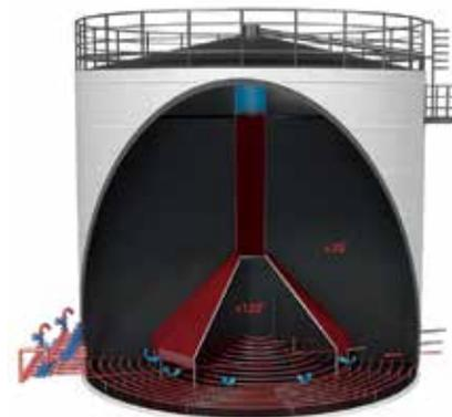
остальной нефтепродукт будет подогрет до температуры 70°C. Разница при купольной системе будет выглядеть так:  $t_{\text{рез}} (70^{\circ}\text{C}) - t_{\text{окружающей среды}} (30^{\circ}\text{C})$ .
