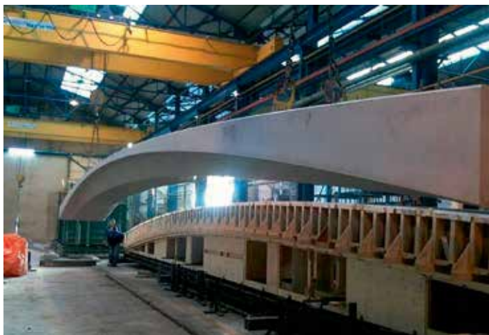
Рис. 9. Пешеходный мост Goosebridge УНПС, Германия, 2016 г. Длина пролета – 20 м. При изготовлении пролетного строения специальная смесь СПФБ, включая стальные волокна, перекачивалась с помощью обычного роторного бетононасоса в опалубочную форму. За исключением предварительно напряженной арматуры, в мосту не использована другая стальная арматура.
