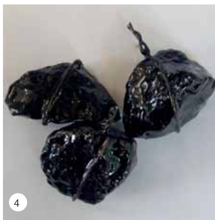
Рис. 3. Внешний вид камней с битумным вяжущим без модификатора и с «Вискодор ПВ-2» после кипячения 1. Битум БНД 70/100 без добавок; 2. БНД 70/100 + 1% «Вискодор ПВ-2»; 3. БНД 70/100 + 1,5% «Вискодор ПВ-2»; 4. БНД 70/100 + 3% «Вискодор ПВ-2»
