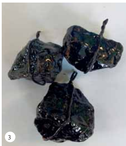
Рис. 3. Внешний вид камней с битумным вяжущим без модификатора и с «Вискодор ПВ-2» после кипячения 1. Битум БНД 70/100 без добавок; 2. БНД 70/100 + 1% «Вискодор ПВ-2»; 3. БНД 70/100 + 1,5% «Вискодор ПВ-2»; 4. БНД 70/100 + 3% «Вискодор ПВ-2»
