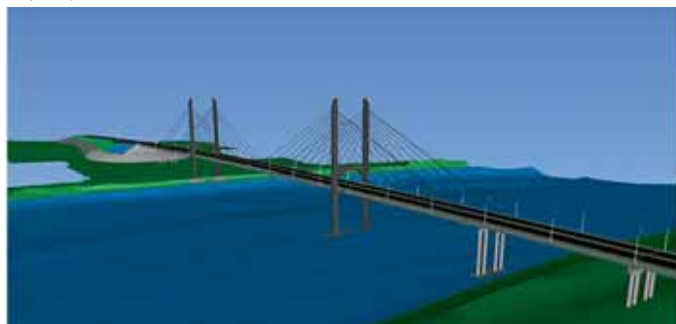
Рис. 4. Цифровая информационная модель мостового перехода через р. Ока на 4-м этапе М-12
