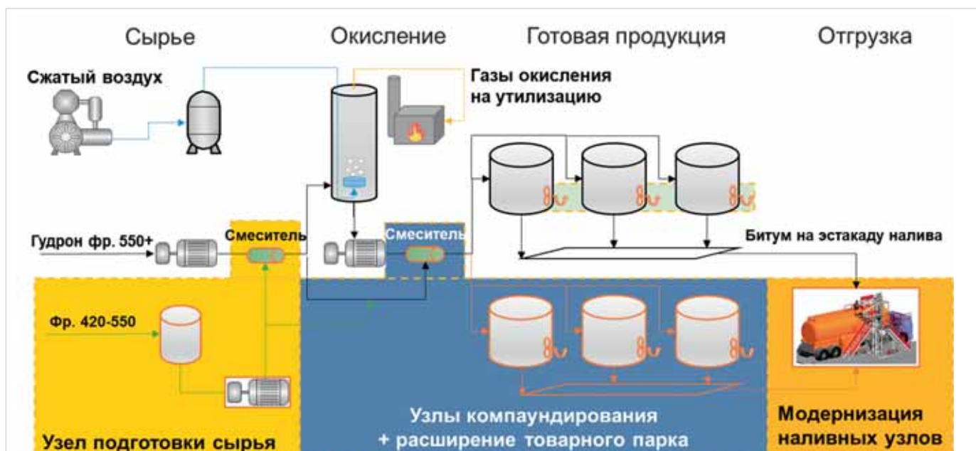
Рис. 3. Схема модернизации битумных производств
