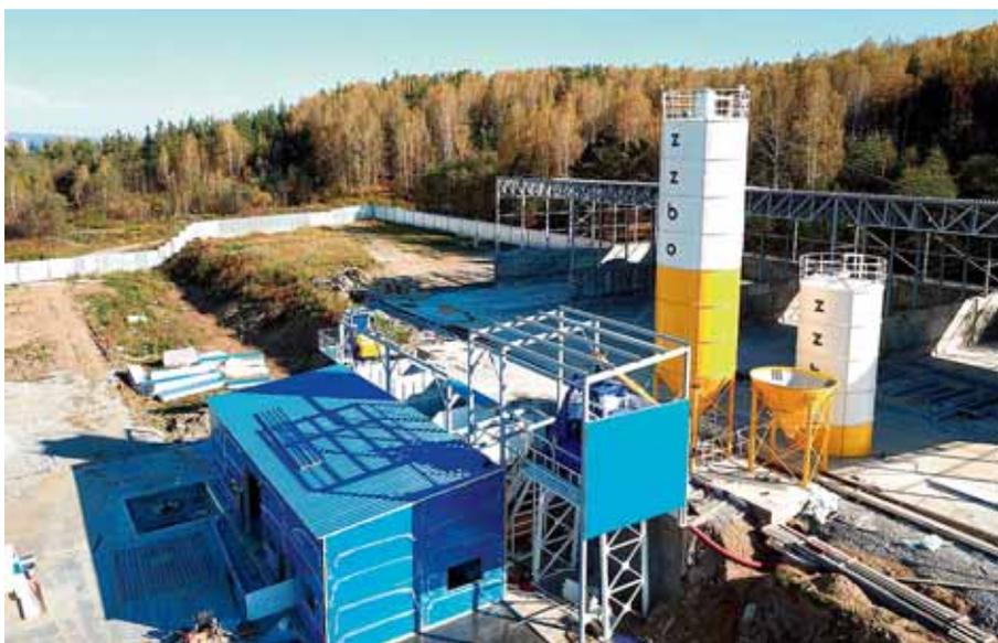
Рис. 7. Бетономесительная установка серии «Флагман» компании ZZBO (Россия)
