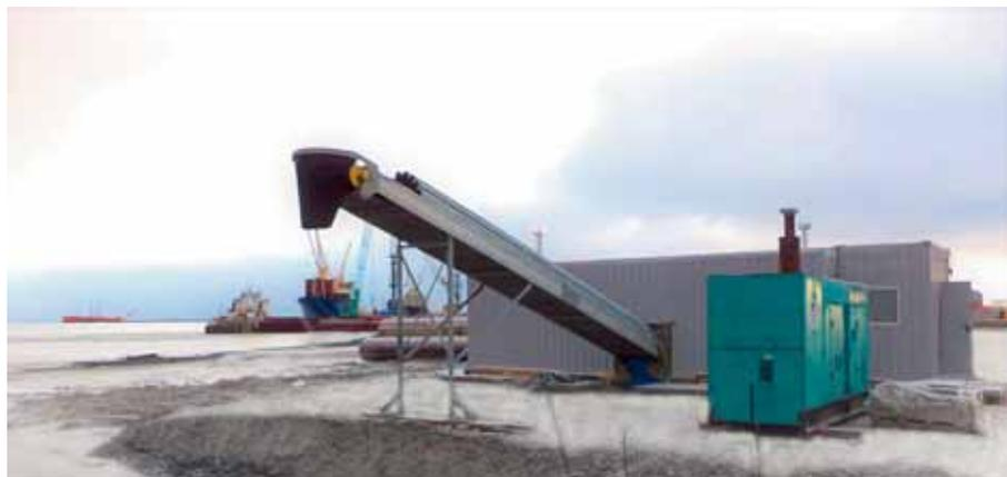
Рис. 1. Зимний вариант бетоносмесительной установки компании FIBO INTERCON (Дания)
