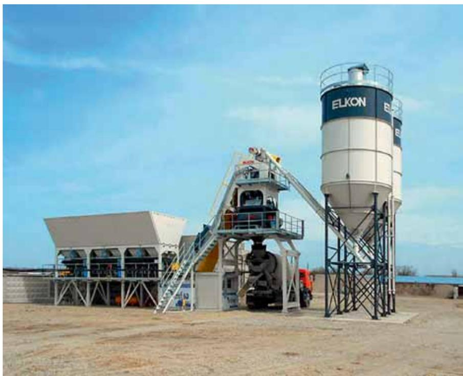
Рис. 5. Бетоносмесительная установка компании ELKON (Турция) для работы зимой
