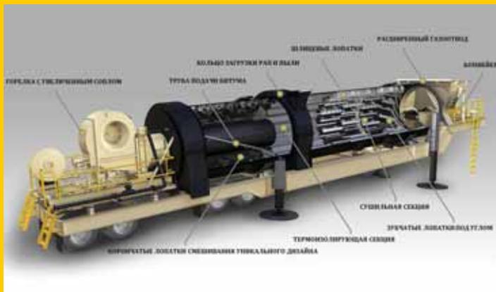
Заводы ALMIX серии UF и DuoDrum (система с двумя барабанами) имеют **самый высокий показатель использования РАП** на тонну производимой асфальтобетонной смеси (до 70%), что существенно снижает себестоимость.
