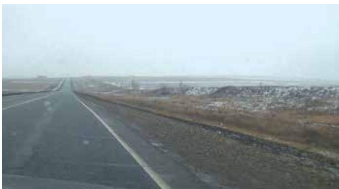
Фото 3. Дорога Волгоград – Саратов зимой. Справа виден снегозащитный вал
