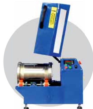
УСТАНОВКА НОРДИК ТЕСТ-РДТ
