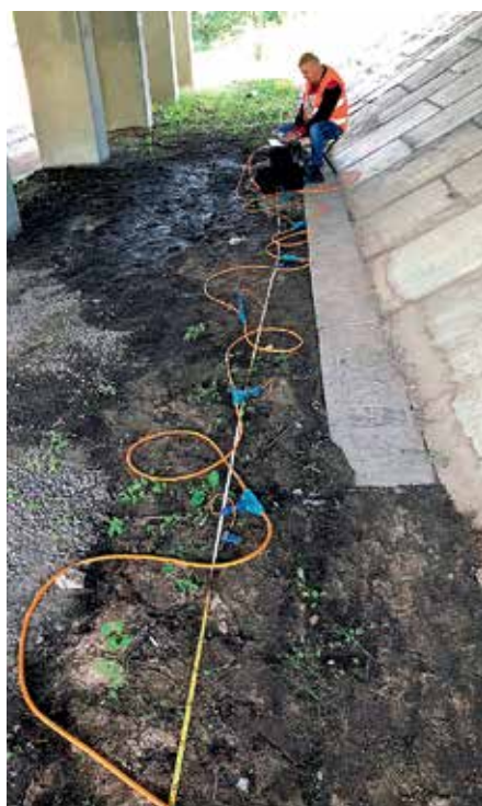
Определение типа фундамента устоя путепровода методом сейсморазведки
