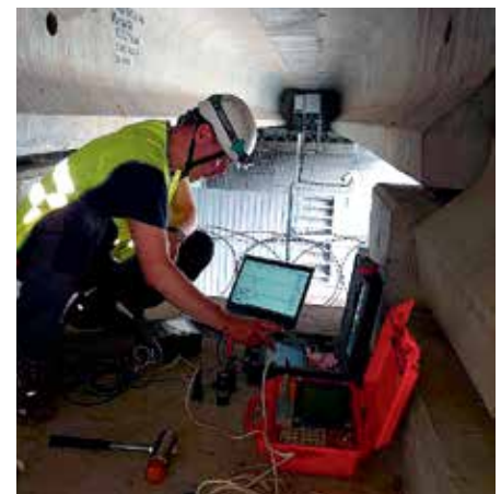
Определение глубины заложения фундамента массивной промежуточной опоры моста с поверхности ригеля сейсмоакустическим методом с помощью четырех различных приборов
