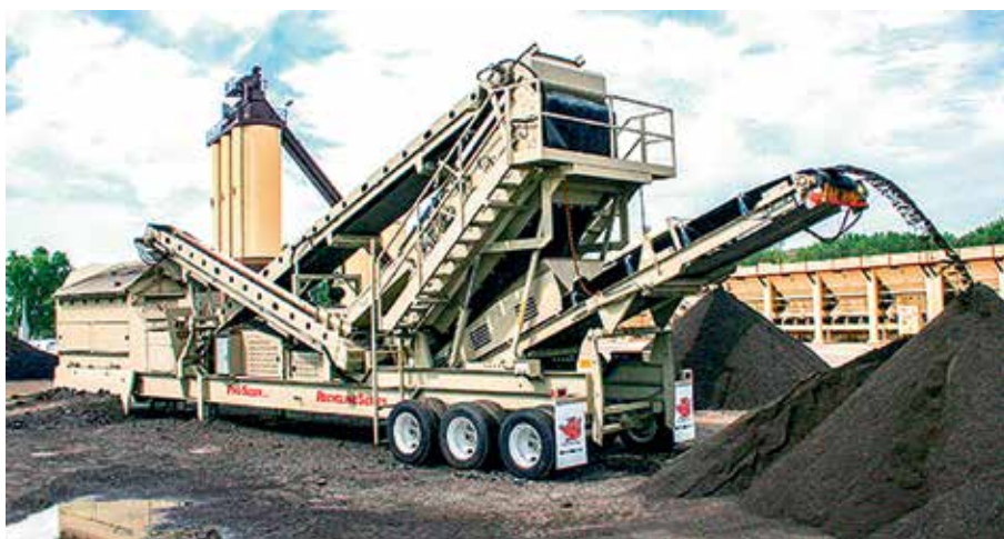
Рис. 6. Мобильная установка Pro-Sizer 2612V компании Astec Mobile Screens для дробления асфальтового гранулята
