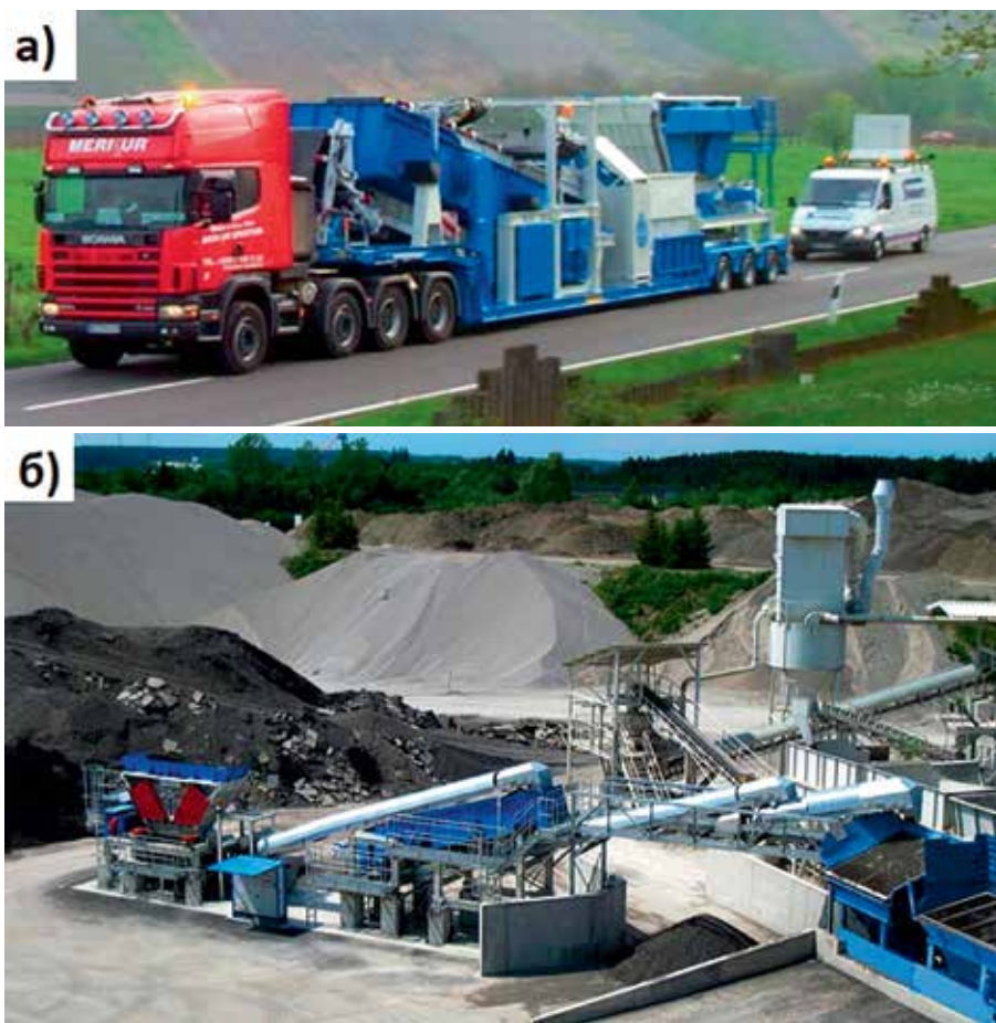
Рис. 3. Грануляторы компании Benninghoven: Варианты исполнения: а) мобильный; б) стационарный
