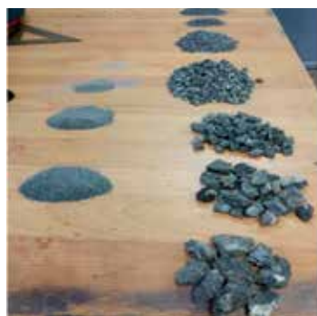
Рис. 10. Общий вид гранулята после отсева (а) и его гранулометрический состав (б): 1- до дробления; 2 - после дробления и добавления цемента.
