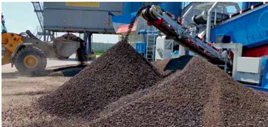
Рис. 5. Асфальтовый гранулят после дробления в грануляторе компании Benninghoven
