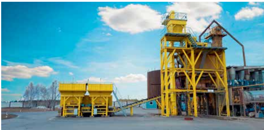
Рис. 9. Установка холодного ресайклинга серии C-Cold компании NFLG (Китай) (добавление до 45% асфальтового гранулята)
