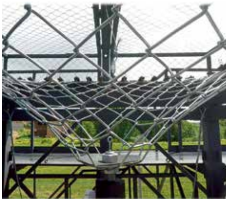
Рис. 5. Механические испытания на продавливание, растяжение и срез анкером
