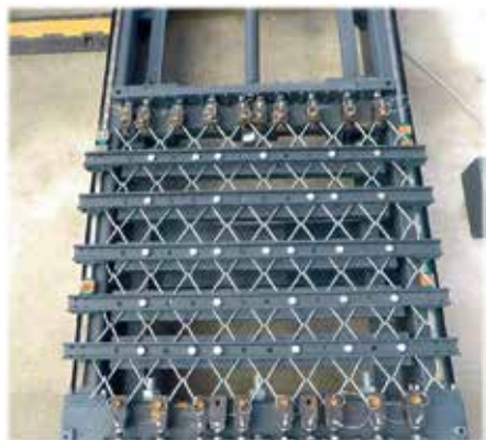
Рис. 5. Механические испытания на продавливание, растяжение и срез анкером
