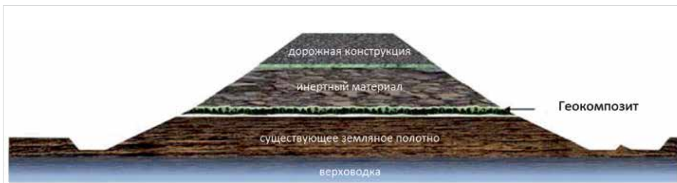
Рис. 2. Геокомполиты, используемые в качестве капилляропрерывающего слоя
