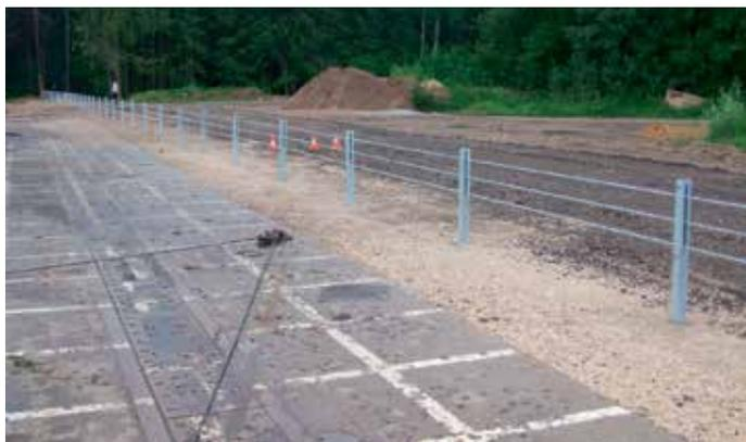
Рис. 2. Трехтросовое ограждение до испытания, 2017–2018 гг
