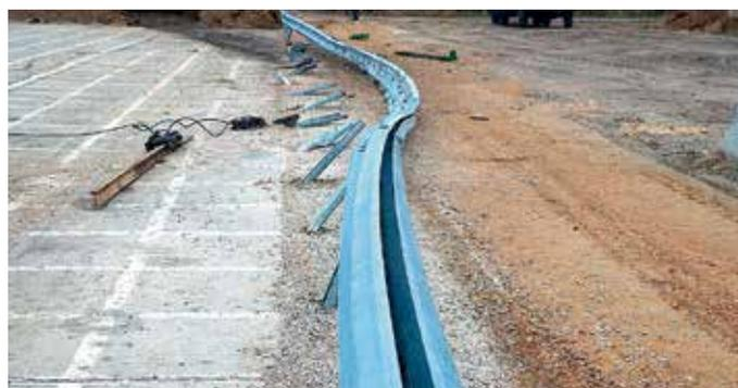
Рис. 9. Дорожное двустороннее барьерное ограждение на стойке «С» после испытания, 2020 г
